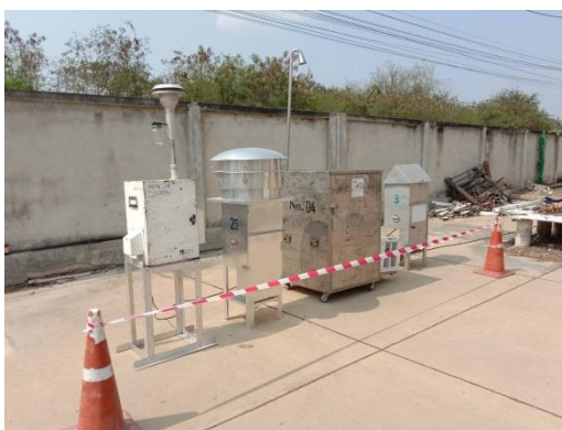
รูปที่ 3.3 การเก็บตัวอย่างคุณภาพอากาศในบรรยากาศ บริเวณภายในหอพัก บริษัท ลักกี้กลาส จำกัด
